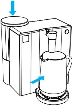
**6.** 1,8 L Leitungswasser in den Wassertank füllen und ein Gefäß unter den Wasser- auslauf stellen.
