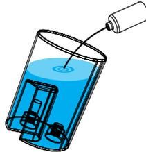
2. 1,7 L Leitungswasser in den Wassertank füllen und 100 ml Desinfektionsmittel (H<sub>2</sub>O<sub>2</sub> in 3% Lösung) hinzufügen.
