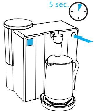
4. Die Start-Stopp-Taste (genau **fünf** Sekunden lang) gedrückt halten, bis im Display „REF“ angezeigt wird. Danach die Start-Stopp-Taste loslassen. Der Desinfektionsvorgang beginnt.
